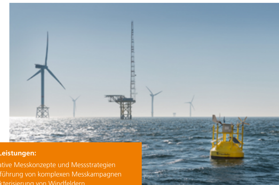
Messkampagne mit einer Lidar-Boje zur Windpotenzialermittlung
