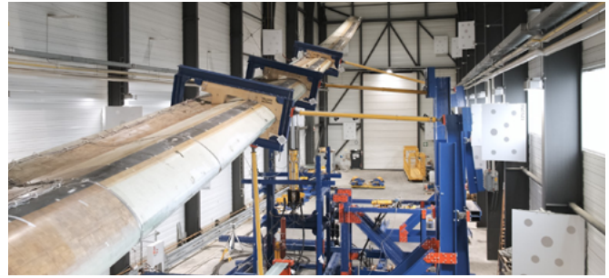
Biaxialer Ermüdungsprüfstand mit Federelement und entkoppelten Massen
